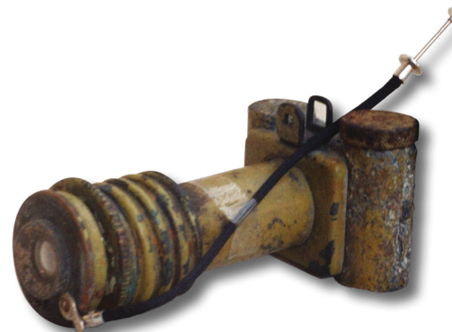
Miniaturowy aparat fotograficzny skonstruowany przez huścowego Szarych Szeregów w Buku. Ze zbiorów IPN
